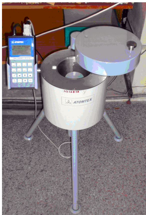
1 – БД, 2 – ось, 3 – гайка, 4 – винт, 5 – экран, 6 – ручка, 7 – сосуд Маринелли, 8 – ножка, 9 – опора, 10 – фиксатор крышки, 11 – крышка, 12 – корпус.
