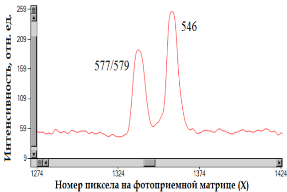
Рисунок 3 – Фрагмент спектра в G-канале, содержащий дублет 577/579 нм и линию 546 нм
