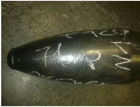
Рисунок 2 – Износ опытных прошивных оправок Ø120 мм
