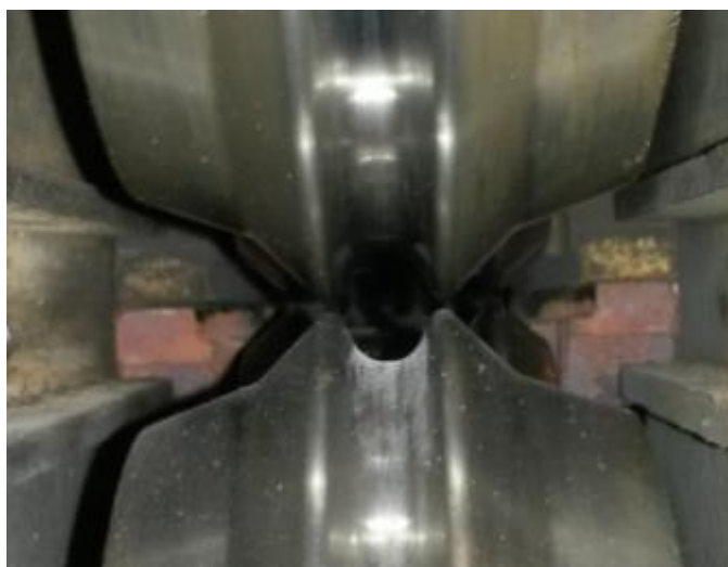
Рисунок 2 – Неприводные клиновидные делительные ролики НДУ
